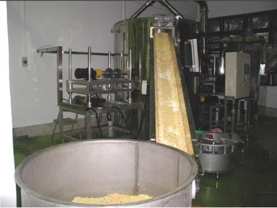
圖三 黑殭菌量產之固體發酵設備之原型機
