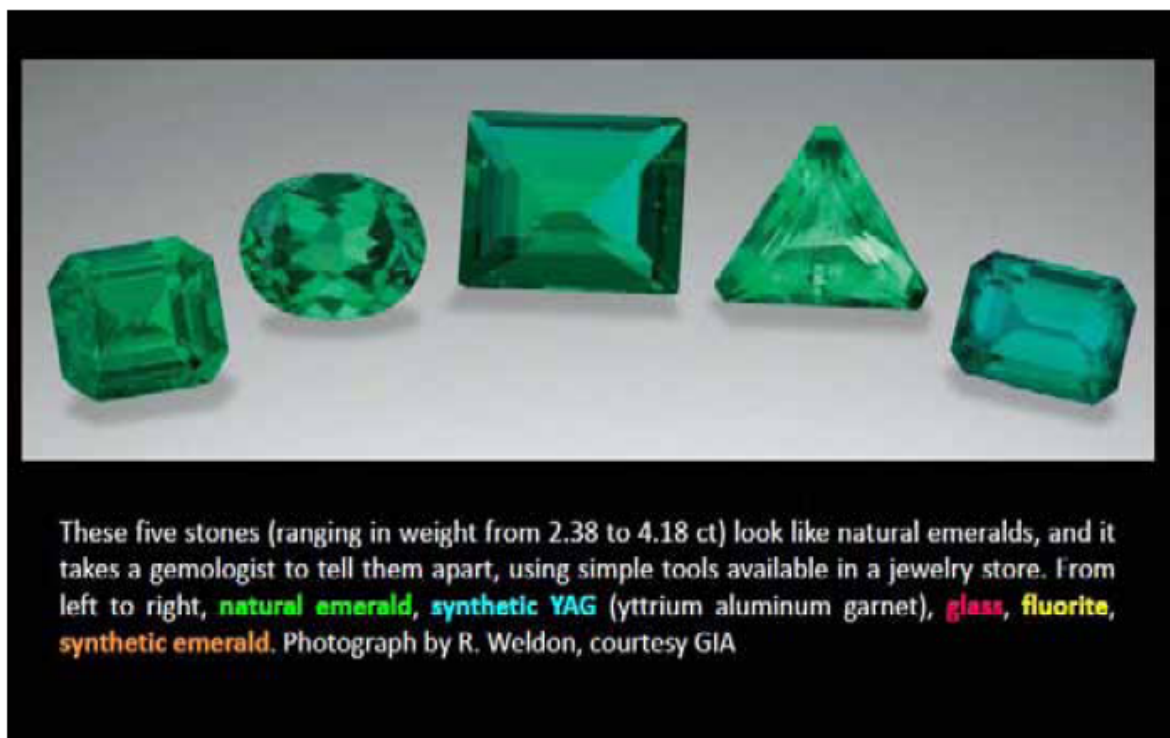
圖 1 珠寶常使用之五種色光綠色寶石之合成與天然寶石（天然翡翠、人造鈮鋁石榴石、玻璃、螢石、人造翡翠）之比較。(J. elements, 5, 2009)
