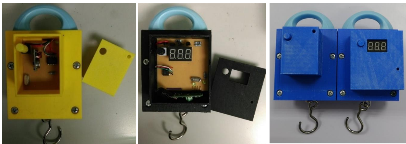
圖 12 發送端(左)、接收端(中)及成品(右)
