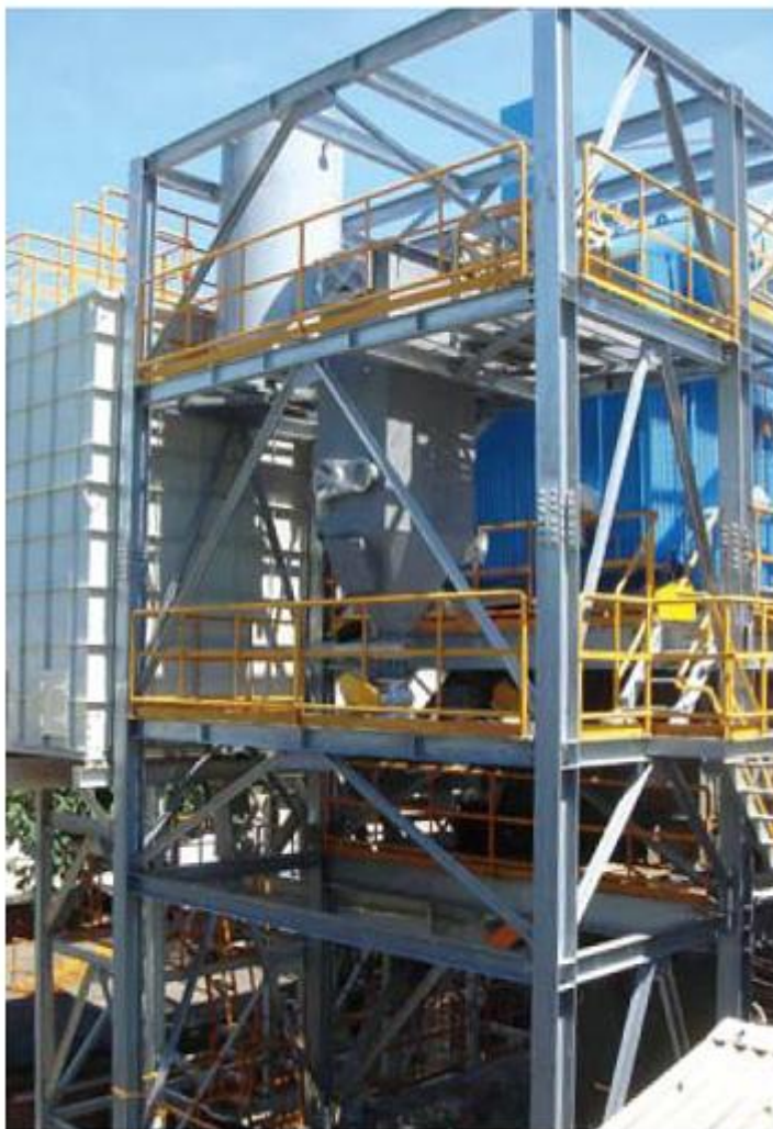
工研院所開發的RDF-5氣泡式流體化床蒸氣鍋爐，最大蒸氣產量是6公噸/時。
