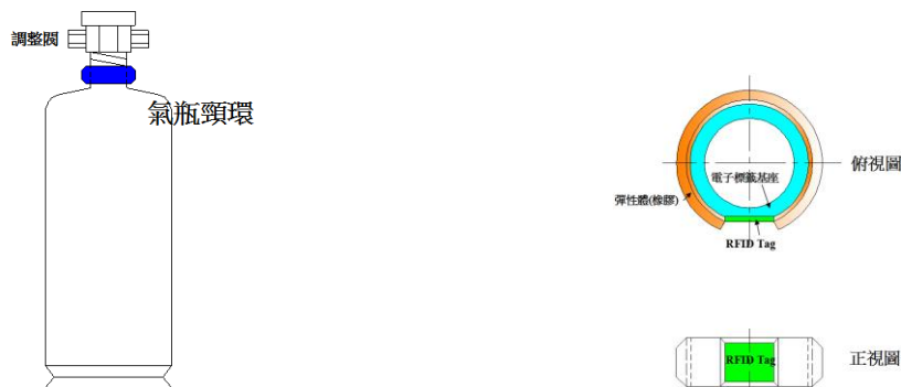
圖一、氣瓶頸環示意圖(藍色圓圈位置) 圖二、環狀電子標籤基座示意圖(俯視圖與正視圖)
