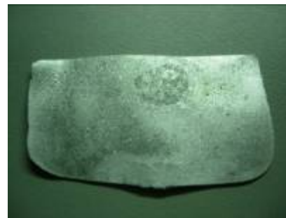
照片 3-8 銀試片高溫加熱後色澤變化
