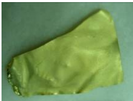
照片 3-1 純金及 K 金試片高溫加熱後色澤變化
