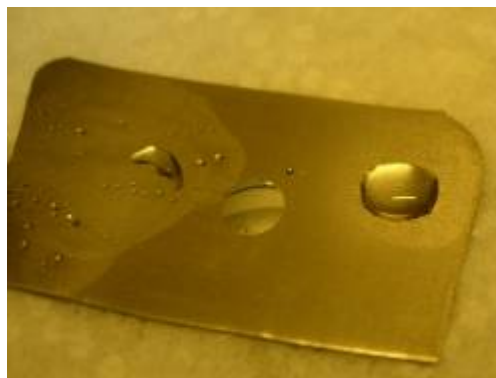
照片 3-20 鹽酸、硫酸、硝酸滴定於鈀試片
