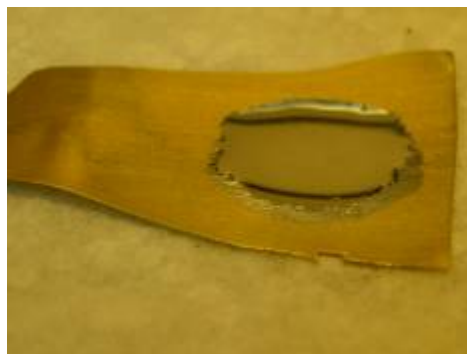
照片 3-2 水銀滴定於純金試片
