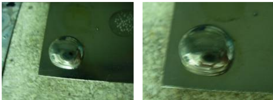
照片 3-14 水銀滴定於鉑-銱試片表面
