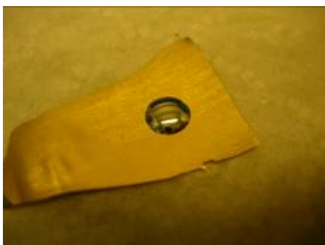
照片 3-2 水銀滴定於純金試片
