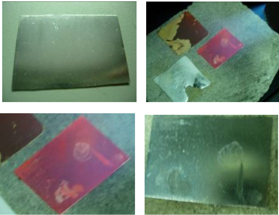
照片 3-13 鉑銱試片高溫加熱後色澤變化
