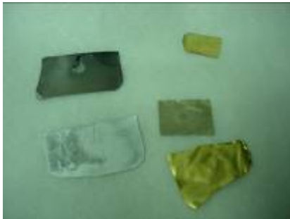
照片 3-8 銀試片高溫加熱後色澤變化
