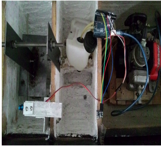
圖 18. MPU6050 與伺服機控制配線
