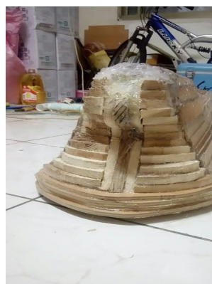
圖 7. 堆疊船頭並填補縫隙
